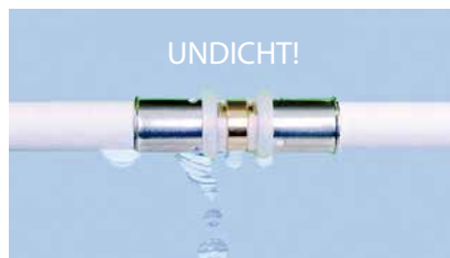
Bei üblichem Anlagendruck geprüfter, unverpresster Fitting (unverpresst-undicht)
