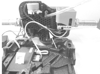
Abb. 8: Verbindungskabel in den Kabelbinder einsetzen
