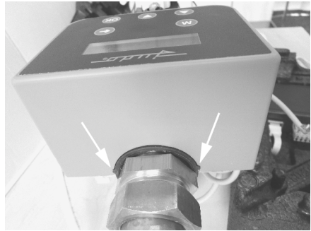
Fig. 11: Enclencher la paroi arrière du boîtier électronique
