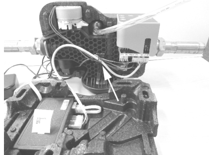
Afb. 8: Plaats de verbindingkabel in de kabelbinder
