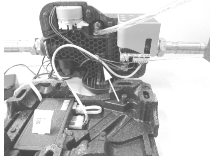
Afb. 8: Plaats de verbindingkabel in de kabelbinder
