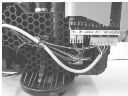
Fig. 7: Brancher les fiches A1 et A2 sur la commande électronique
