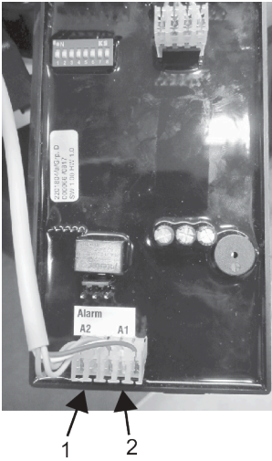
Abb. 3: Kabelanschluss an Steuerung
