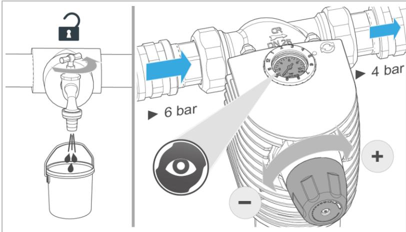
1. Stellen Sie den gewünschten Nachdruck am Druckminderer-Handrad ein (rechts drehen = Druckerhöhung, links drehen = Druckreduzierung).
