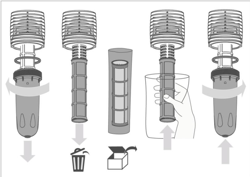
1. Schrauben Sie die Filterglocke von Hand auf. Benutzen Sie bei Bedarf einen Bandschlüssel.
