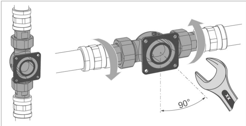
1. Drehen Sie den Anschlussflansch in die zu Ihrer Durchflussrichtung passende Position (siehe Kennzeichnung auf dem Anschlussflansch).
