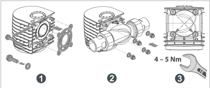
1. Setzen Sie die Sechskantschrauben mit Scheiben in die Aussparungen am Filterkopf.
