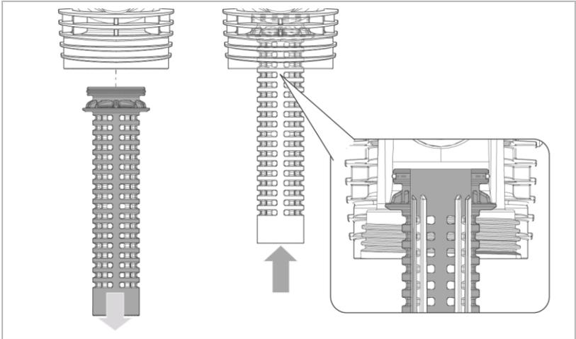
5. Reinigen Sie das Stützgewebe bei starker Verschmutzung.
