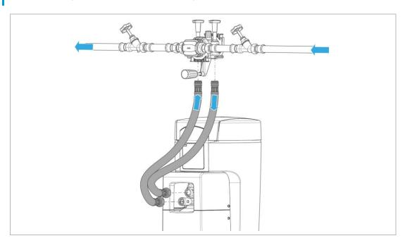
▶ Beachten Sie die durch Pfeile am Anschlussmodul und an der Enthärtungsanlage softliQ:SE gekennzeichnete Durchflussrichtung.
