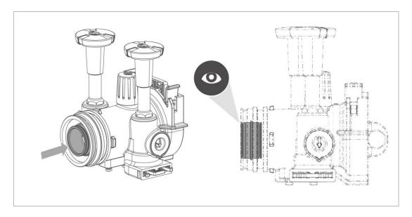
2. Stecken Sie die Steckkupplung bis zum Anschlag in das Anschlussmodul.
