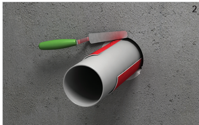
Restpalt rauchgasdicht (mit z. B. Pacifyre® FPM Brandschutzmörtel) verschließen.
