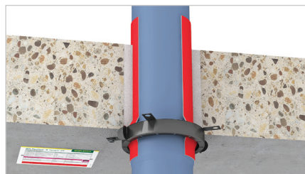
Halteflaschen einge- mörtelt (90° umgebogen)
