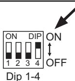
Die Adresseneinstellung am BM erfolgt mittels Dip-Schalter am BM (siehe Bedienungsanleitung BM).
