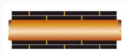
Gelbe Linien kennzeichnen die Nahtverklebung
