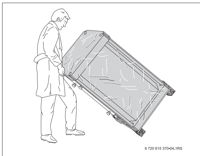
Sl.4 Postavljanje spremnika tople vode
