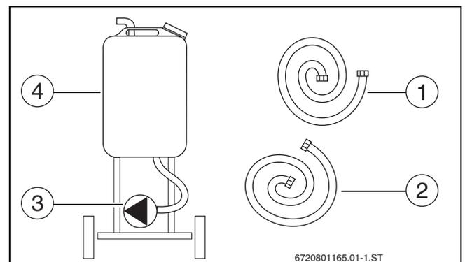
Bild 26 Bestandteile einer Befülleinrichtung
