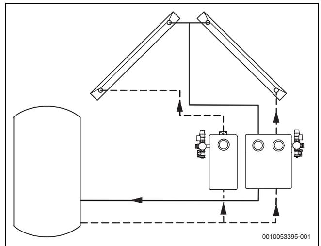
Bild 5 2 Kollektorfelder (Ost/West) mit 1- und 2-Strang-Solarstation
