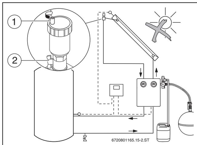
Bild 45 Entlüfter und Kugelhahn schließen
