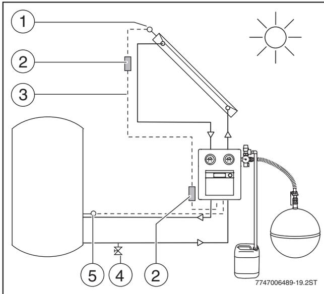
Bild 25 Temperaturfühler an Solarstation mit integriertem Regler
