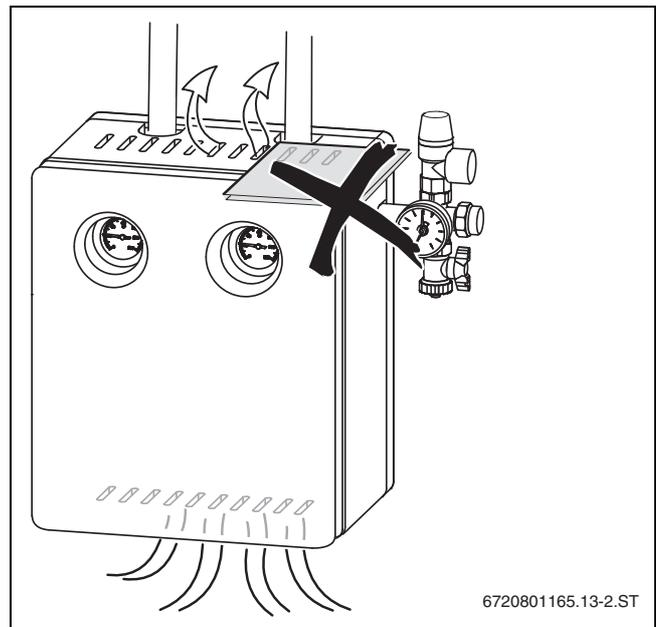
Bild 49 Lüftungsschlitze nicht abdecken
