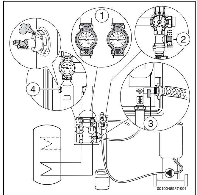
Bild 37 Füll- und Entleerhähne schließen und öffnen
