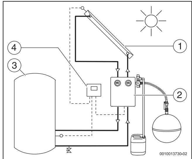
Bild 8 Beispielhafte Darstellung einer Solaranlage
