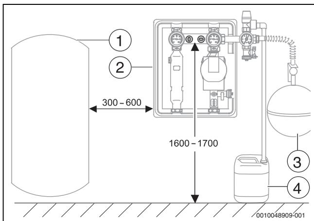
Bild 19 Empfohlene Aufstellung (Maße in mm)
