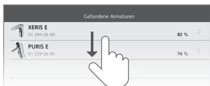
Wenn eine batteriebetriebene Armatur nicht umgehend angezeigt wird, ist die Armatur manuell auszulösen. Anschließend muss die Armaturensuche neu gestartet werden.
