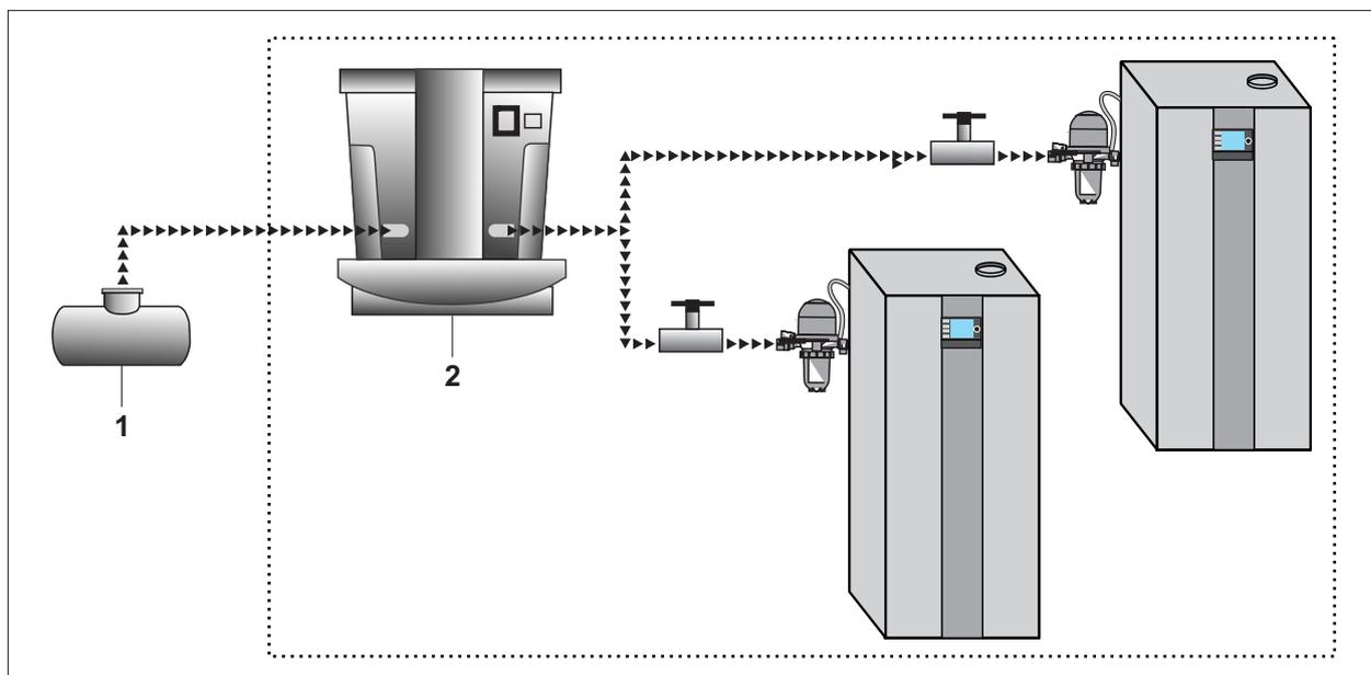
Abb. 4.8 Brennstoffversorgung
