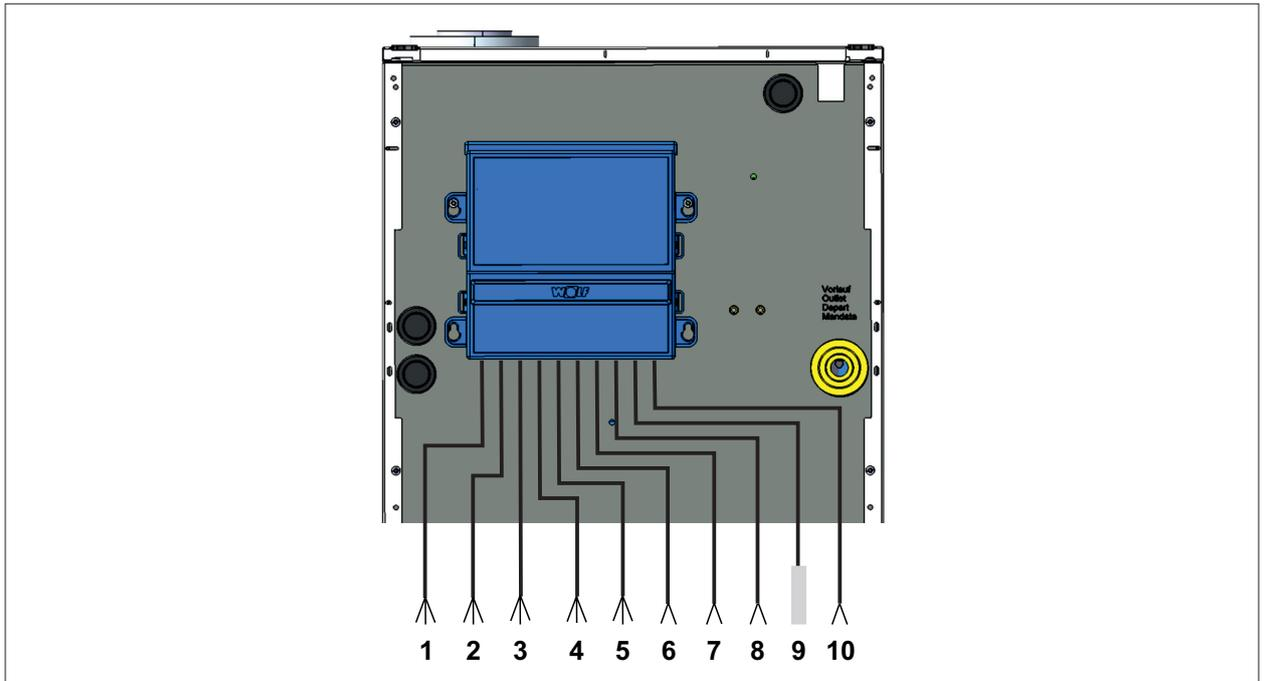
**Abb. 5.23 Elektroanschluss Regelungskasten**
