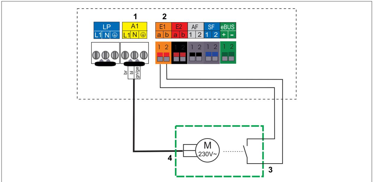
Abb. 12.3 Elektroanschluss Abgasklappe
