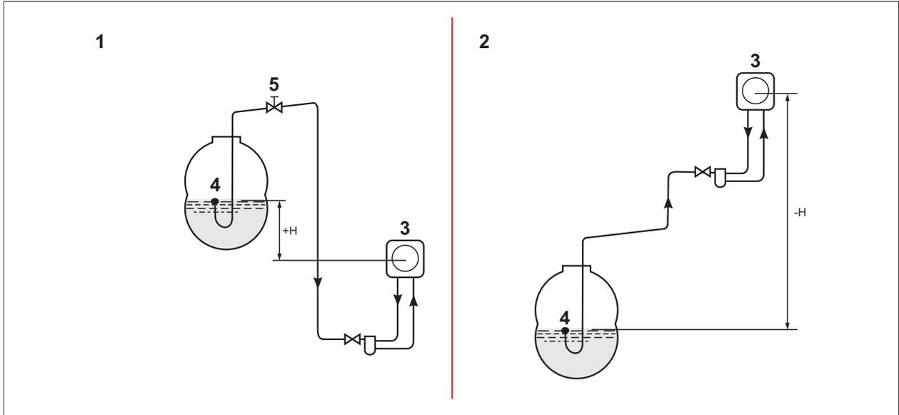
**Abb. 4.3 Schwimmende Absaugung**
