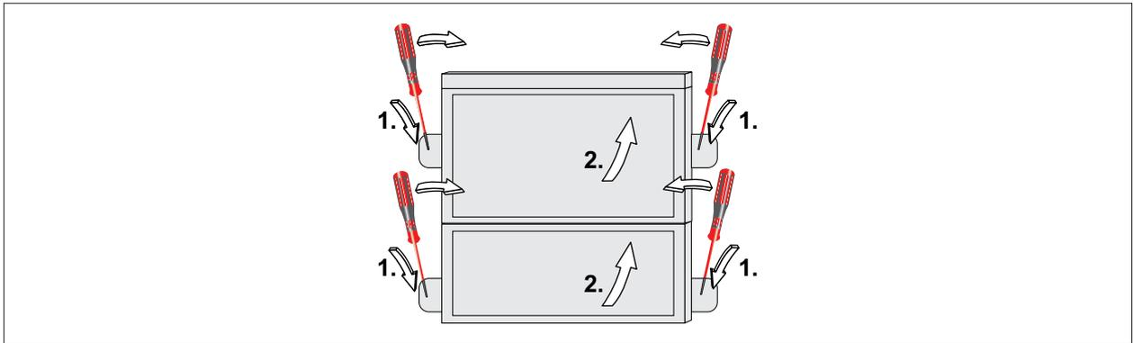
Abb. 5.18 Elektroanschlusskasten öffnen
