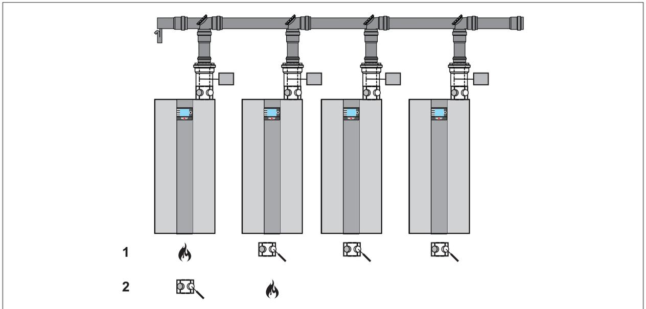
Abb. 6.7 Abgaskaskade
