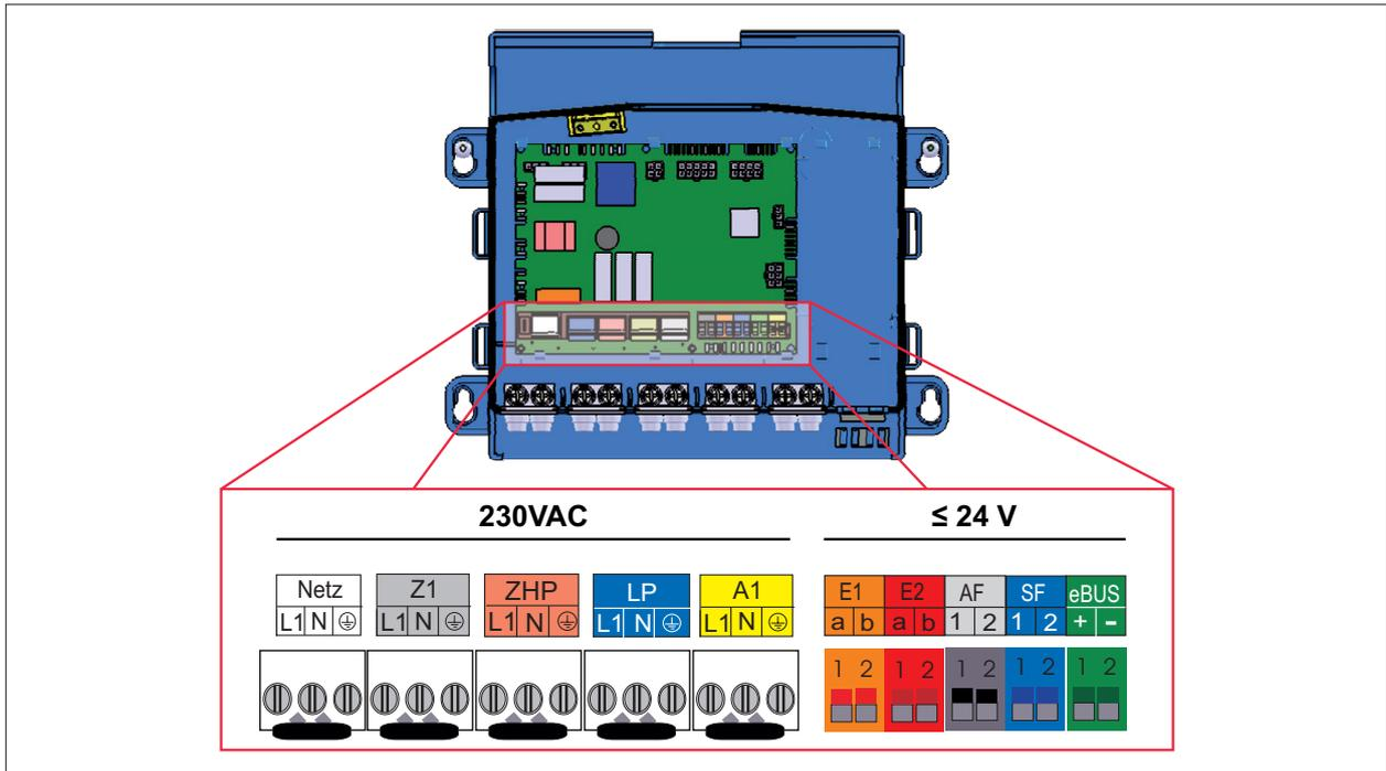
Abb. 5.24 Klemmenbelegung Elektroanschlusskasten
