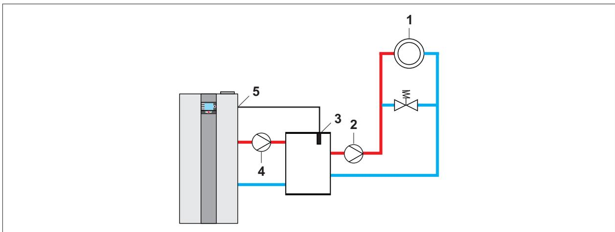
**Abb. 12.9 Anlagenkonfiguration 12 - Hydraulische Weiche mit Sammlerfühler**
