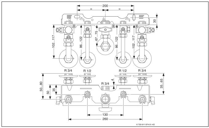
Bild 6 Anschlussmaße Montageanschlussplatte Zubehör Nr. 992
