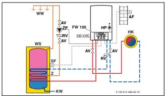
Bild 16 Beispiel mit witterungsgeführtem Regler FW 100 und Warmwasser-Zirkulation
