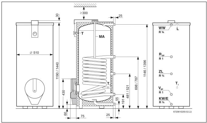
Bild 72 Bau- und Anschlussmaße SK 160/200-4 ZB
