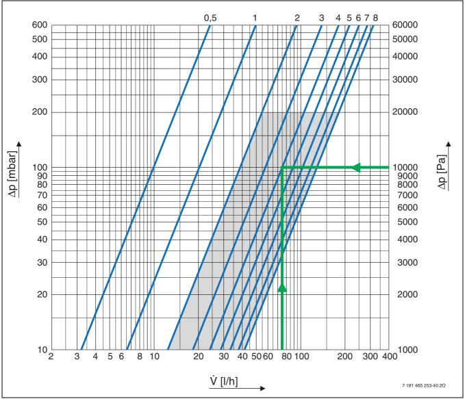
Bild 108 Durchflussdiagramm für voreinstellbare Ventile
