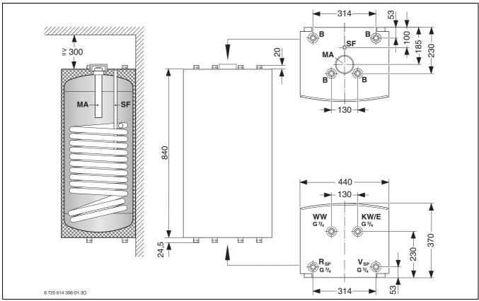
Bild 50 Bau- und Anschlussmaße
