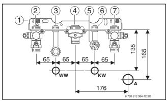
Bild 60 Aufputzanschlüsse mit Wandabstand 60 mm
