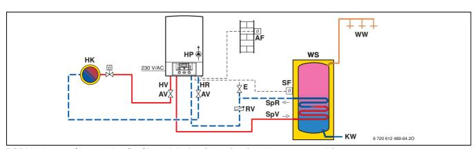
Bild 69 Cerastar/CerastarComfort/Ceramini mit nebenstehendem Warmwasserspeicher
