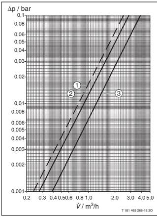
Bild 89 Druckverlust SK 400-1 solar
