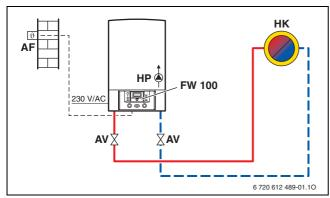
Bild 9 Beispiel mit witterungsgeführtem Regler FW 100
