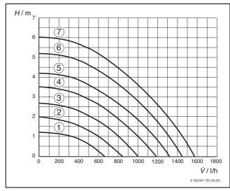
Bild 37 Pumpenkennlinien bei ZWR-Geräten
