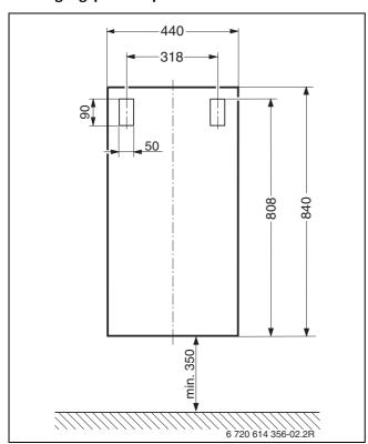
Bild 51 Befestigungspunkte
