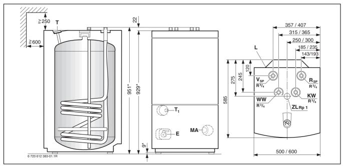
Bild 55 Bau- und Anschlussmaße ST 120-2 E. und ST 160-2 E. (Maßangaben hinter einem Schrägstrich beziehen sich auf die größere Speicherausführung)
