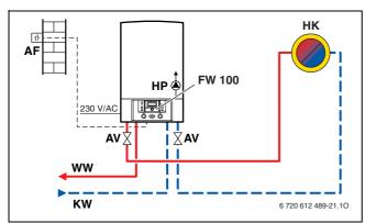
Bild 20 Beispiel mit witterungsgeführtem Regler FW 100
