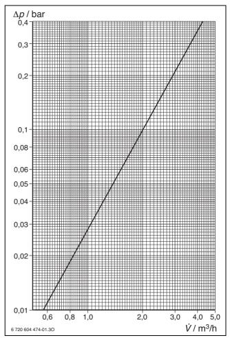
Bild 49 Druckverlust der Heizschlange in bar
