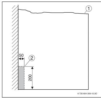
Bild 64 Holzummantelung Zubehör Nr. 601 mit Aussparung
