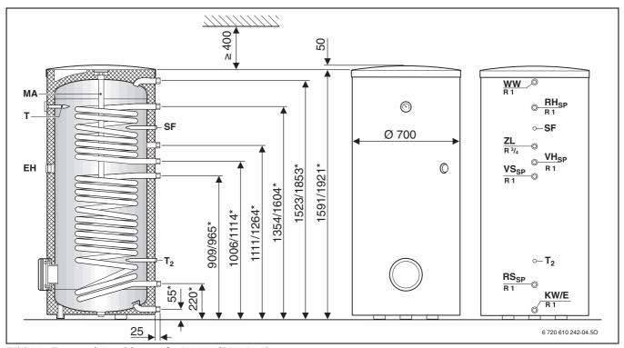
Bild 86 Bau- und Anschlussmaße SK 400/500-1 solar
