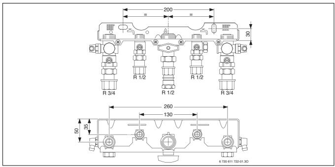
Bild 5 Anschlussmaße Montageanschlussplatte Zubehör Nr. 991
