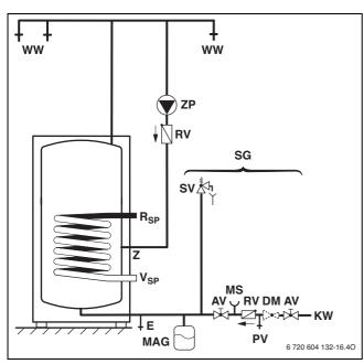
Bild 39 Warmwasserseitiges Anschluss-Schema
