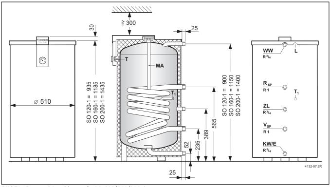
Bild 70 Bau- und Anschlussmaße SO 120/160/200-1
