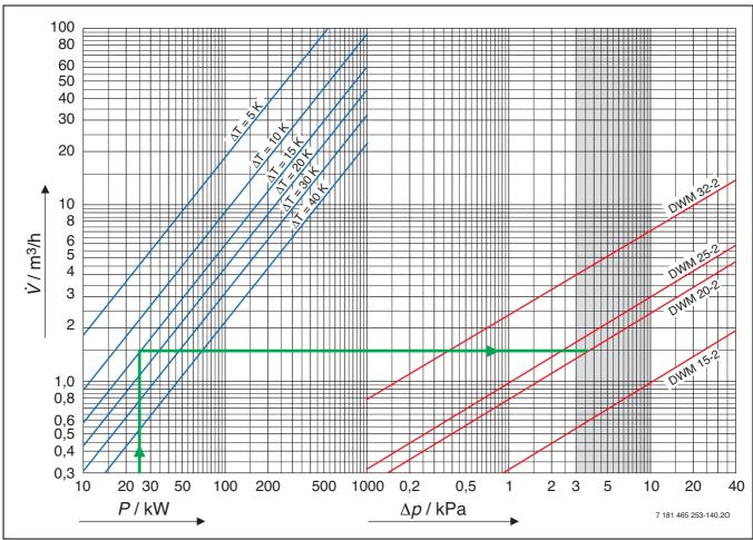
Bild 106 Auslegungsdiagramm für 3-Wege-Mischer
