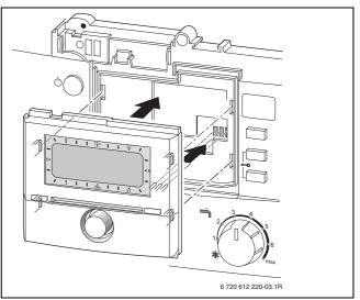
Bild 103 Einbau in das Heizgerät
