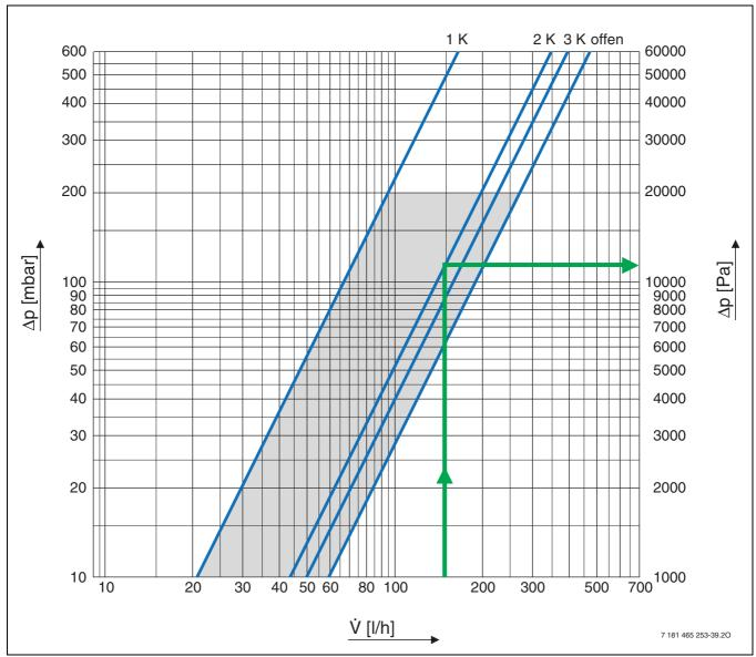
Bild 107 Durchflussdiagramm für Universalventile
