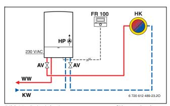
Bild 22 Beispiel mit raumtemperaturgeführtem Regler FR 100
