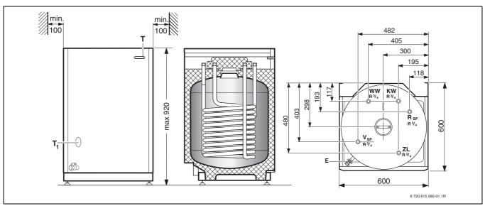
Bild 74 Bau- und Anschlussmaße SE 120-1
