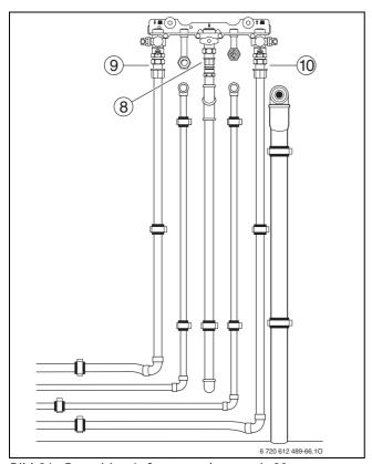
Bild 61 Bauseitige Aufputzverrohrung mit 60 mm Wandabstand
