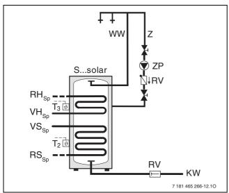
Bild 81 Trinkwasserseitiges Anschluss-Schema bei solarer Warmwasserbereitung
