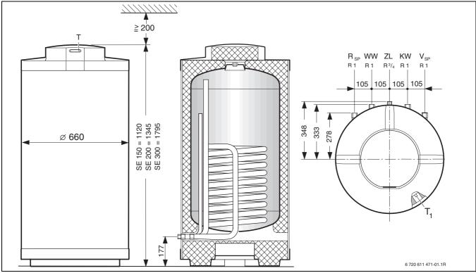
Bild 75 Bau- und Anschlussmaße SE 150/200/300-1
