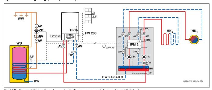
Bild 19 Beispiel Schnellmontageset mit Warmwasserspeicher und zwei Heizkreisen
