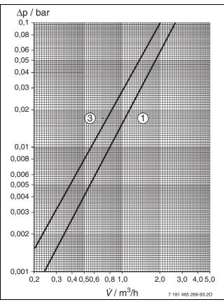
Bild 91 Druckverlust SP 750 solar
