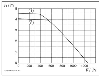
Bild 32 Konstantdruck bei Z.N-Geräten
