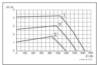
Bild 33 Konstantdruck bei ZWR- Geräten
