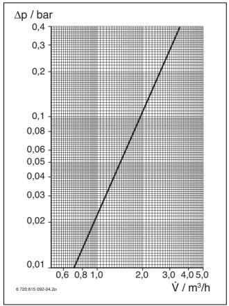
Bild 79 Druckverlust der Heizschlange in bar
