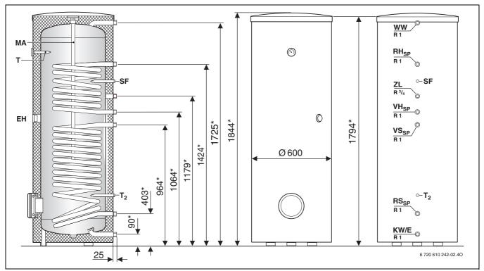
Bild 85 Bau- und Anschlussmaße SK 300-1 solar
