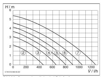
Bild 36 Pumpenkennlinien bei Z.N-Geräten
