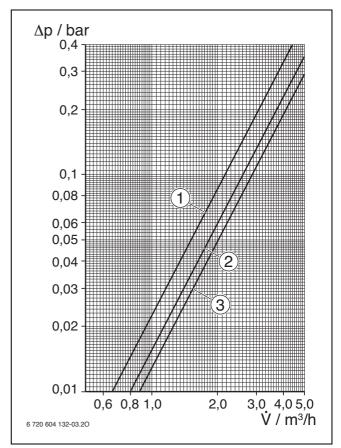
Bild 78 Druckverlust der Heizschlange in bar
