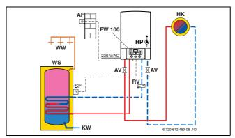
Bild 15 Beispiel mit witterungsgeführtem Regler FW 100
