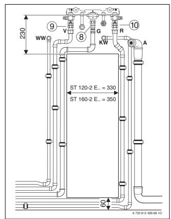
Bild 63 Bauseitige Aufputzverrohrung ohne Wandabstand
