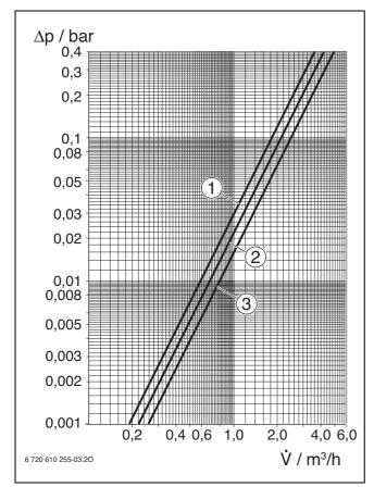
Bild 77 Druckverlust der Heizschlange in bar
