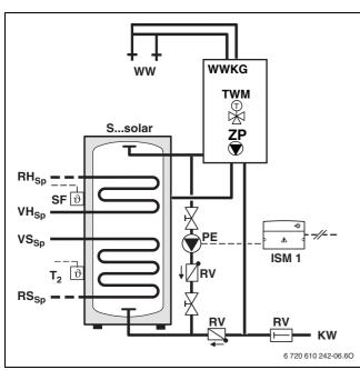
Bild 83 Trinkwasserseitiges Anschluss-Schema bei solarer Warmwasserbereitung
