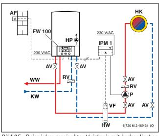
Bild 25 Beispiel ungemischter Heizkreis mit hydraulischer Weiche
