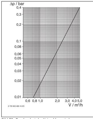
Bild 76 Druckverlust der Heizschlange in bar
