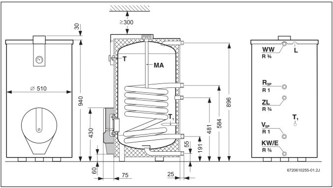
Bild 71 Bau- und Anschlussmaße SK 120-4 ZB
