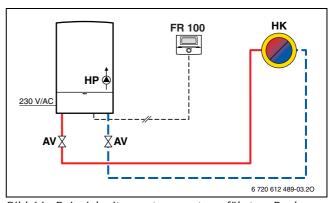
Bild 11 Beispiel mit raumtemperaturgeführtem Regler FR 100
