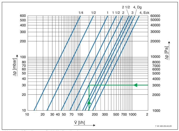
Bild 109 Durchflussdiagramm für Rücklaufverschraubungen
