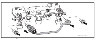
Bild 31 Überströmventil Zubehör Nr. 997 für Montageanschlussplatte Zubehör Nr. 991 bis Nr. 994
