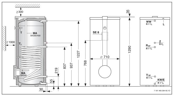
Bild 73 Bau- und Anschlussmaße SK 300-3 ZB
