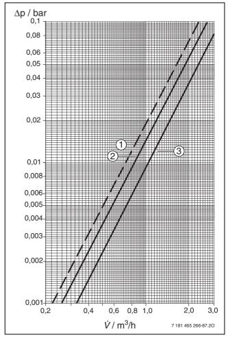
Bild 90 Druckverlust SK 500-1 solar
