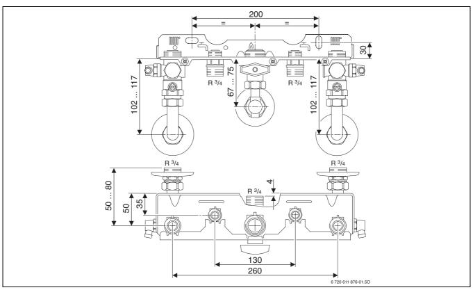
Bild 4 Anschlussmaße Montageanschlussplatte Zubehör Nr. 994
