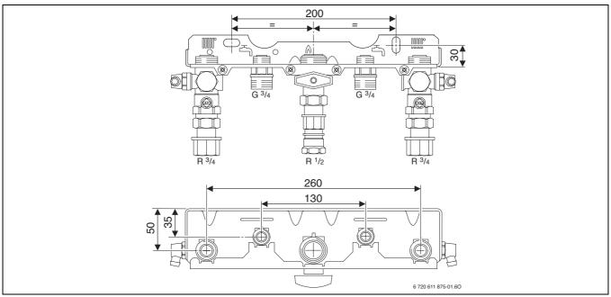
Bild 3 Anschlussmaße Montageanschlussplatte Zubehör Nr. 993
