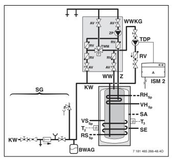
Bild 84 Trinkwasserseitiges Anschluss-Schema bei solarer Heizungsunterstützung
