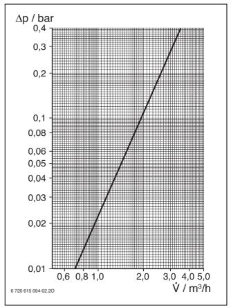
Bild 80 Druckverlust der Heizschlange in bar
