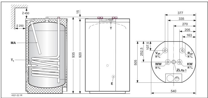
Bild 56 Bau- und Anschlussmaße ST 120-1 Z
