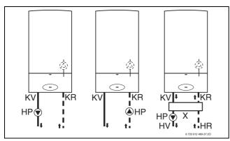
Bild 38 Reihenschaltung von Heizungspumpen
