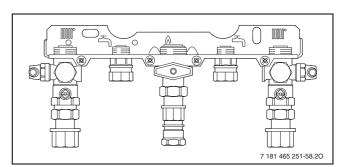
Bild 29 Montageanschlussplatte mit Verschlusskappen
