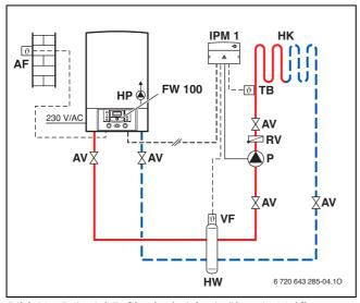
Bild 13 Beispiel Fußbodenheizkreis über 1000 l/h
