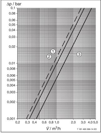
Bild 88 Druckverlust SK 300-1 solar
