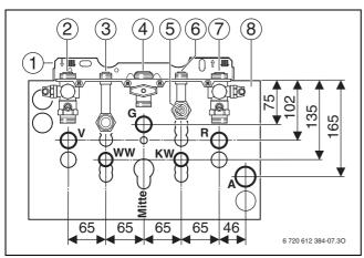
Bild 57 Unterputzanschlüsse
