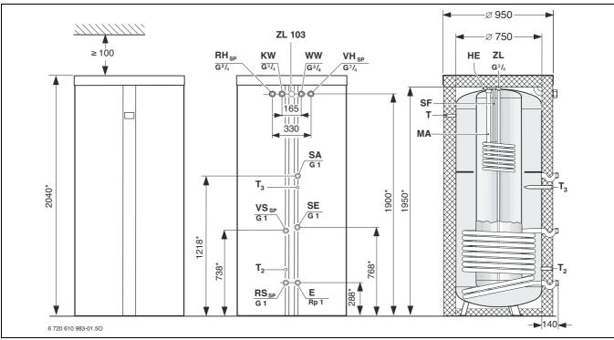
Bild 87 Bau- und Anschlussmaße SP 750 solar
