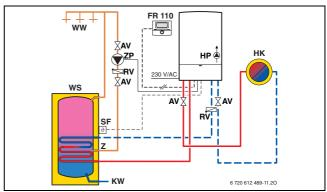
Bild 18 Beispiel mit raumtemperaturgeführtem Regler FR 110 und Warmwasser-Zirkulation
