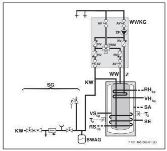
Bild 82 Trinkwasserseitiges Anschluss-Schema bei solarer Heizungsunterstützung
