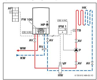
Bild 24 Beispiel Fußbodenheizung über 1000 l/h
